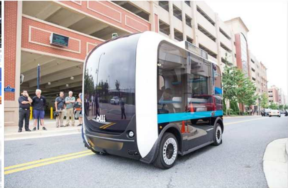
올리(2016년) 가격 미정 3D 프린터로 만든 12인승 전기차 버스. IBM의 인공지능 탑재해 자율주행이 가능한 자동차
